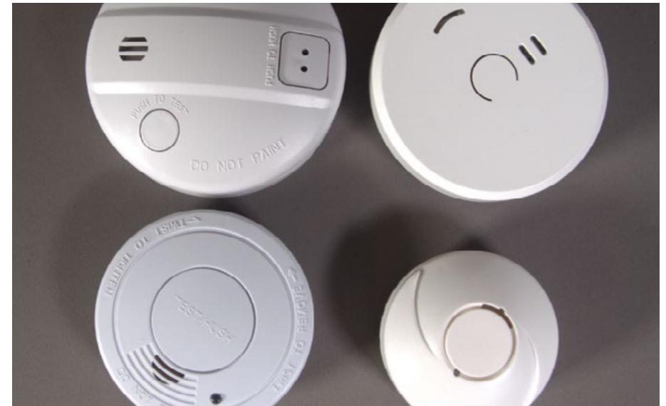
■ Kuva 4. Vaihtelevia merkintöjä palovaroittimissa. Tuotteiden välillä oli eroja siinä, miten hyvin painikkeet tai merkkivalot on käyttäjälle kuvattu. Joissain tapauksissa esimerkiksi painikkeen toimintatarkoitus ja käyttötapa selvisi vasta ohjeista.
