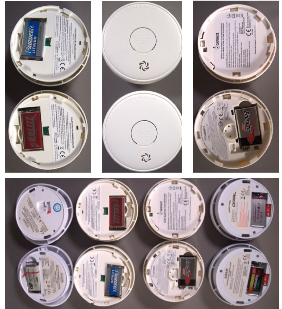
■ Kuva 5. Eri tuoteperheiden palovaroittimien rakenteita, kun vertailtavana oli 10 vuoden akuilla tai paristoilla toimivia palovaroittimia sekä perinteisempiä 9V paristoilla toimivia palovaroittimia.
