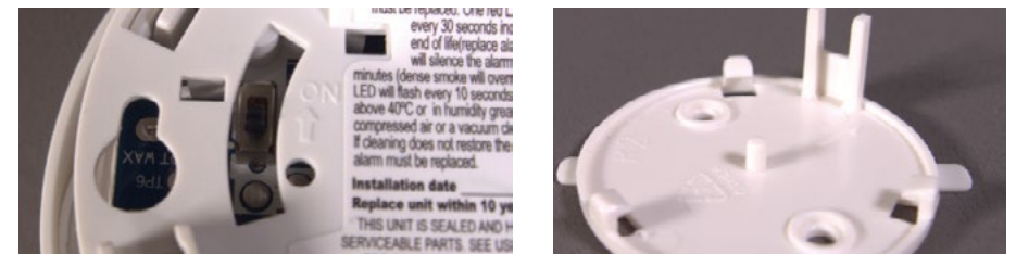
■ Kuva 9. 10 vuoden palovaroittimien käyttöönottoon liittyvien kytkimien eroja.
