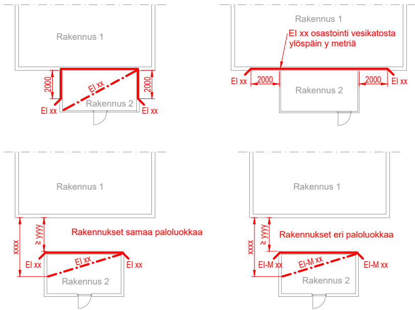
■ Kuva 19. Esimerkki, palo-osastointimerkinät: Rakennuksen ulkopuolinen tila (rakennus 2) rakennuksessa 1 kiinni tai rakennuksesta irti ja rakennukset samaa tai eri paloluokkaa (Kuva antaa ohjeita vain piirustusmerkintöjen tarkkuudelle ja esittämistavalle – ei paloteknisten ratkaisujen tulkinnoille tai vaadittaville etäisyyksille)
