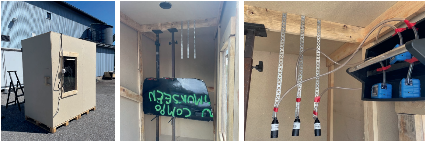
Kuva 1: Tutkimuskammio sekä kuitukeräimet.
