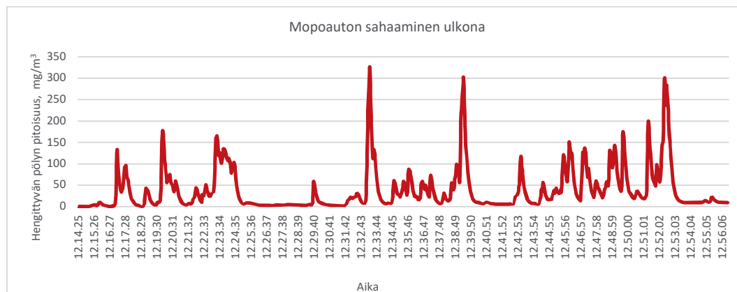
Kuva 5: Hengittyvän pölyn pitoisuusvaihtelu työstäjän hengitysvyöhykkeellä sahattaessa lasikuituista mopoautoa ulkona.
