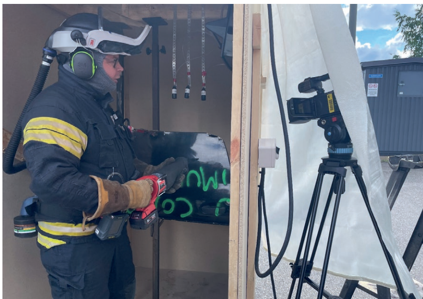
Kuva 3: IOM- ja 37 mm -keräimet sekä suoraanosoittava hiukkasmittari työstäjän päällä.
