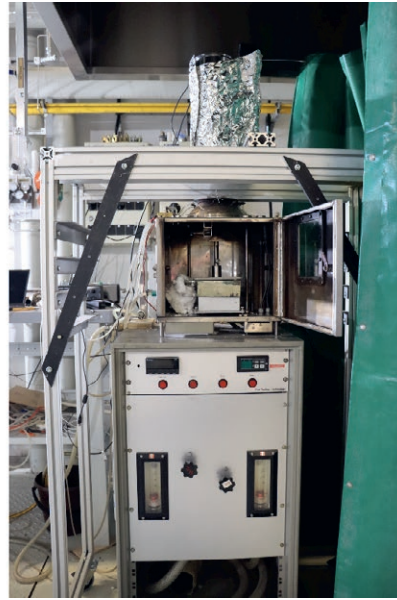
Kuva 1: Vasemmalla kaa- viokuva ja oikealla valokuva koejärjestelystä. 1) IR-kame- ra suojakotelossaan, 2) paineilmapuhallus, 3) IR-kameran ohjaustieto- kone, 4) kartiolämmitin, 5) näyte pitimessään, 6) vaaka, 7) tyypivirtauksen sisääntulo, 8) lämpöparilan- ka, 9) dataloggeri, 10) da- taloggerin ohjaustietokone. 8, 9 ja 10 olivat käytössä ai- noastaan testattaessa 20 cm pitkiä näytteitä.
