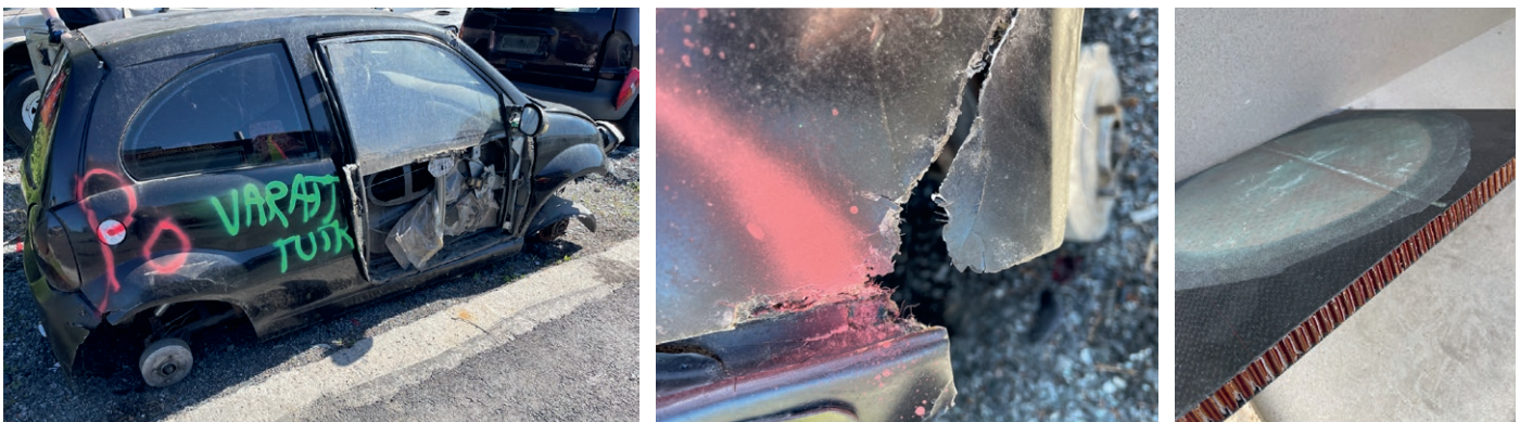
Kuva 2: Lasikuituinen mopoauto sekä hunajakennokomposiittilevy.
