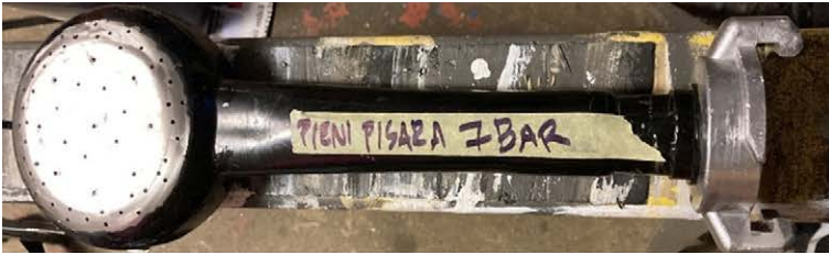
Kuva 10. Testiä varten tehdyt suuttimet, pieni ja suuri pisara.
