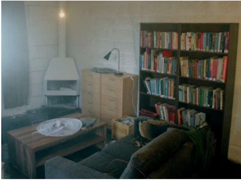
Kuva 4 Automaattisella sammutuslaitteistolla suojattu huoneisto VTT:n Pelastusopistolla tekemien polttokokeiden jälkeen. Huoneiston sohva syttyi tupakasta palamaan. Koejärjestelyt vastasivat aiemmin kuvassa 2 esitettyä polttokoetta, joka tehtiin ilman automaattista sammutuslaitteistoa. Pelastuslaitoksen sammutustoiminta aloitettiin tässäkin tapauksessa 18 minuutin kuluttua syttymästä, vaikka hälytys saadaan suojatuissa kohteissa usein aiemmin kuin suojaamattomissa kohteissa. Vahingot muodostuvat yleensä huomattavasti pienemmiksi, kun tila on suojattu automaattisella sammutuslaitteistolla. Tämä todettiin myös polttokokeissa, eivätkä olosuhteet muuttuneet missään vaiheessa ihmiselle hengenvaarallisiksi.
