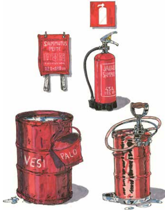
Kuva 13. Alkusammutuskalustoa: käsisammutin, sankoruisku, vesisaavi ja paloämpäri sekä sammutuspeite.
