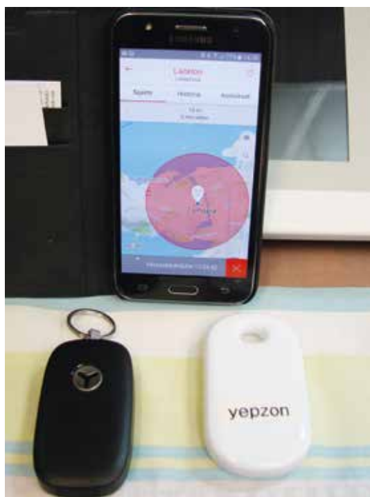
Kuva 1. Kaksi esimerkkiä GPS-turvapaikanninlaitteesta. Vasemmanpuoleisessa laitteessa SOS-turvanappi. Laitteiden seuranta tapahtuu älypuhelimella
